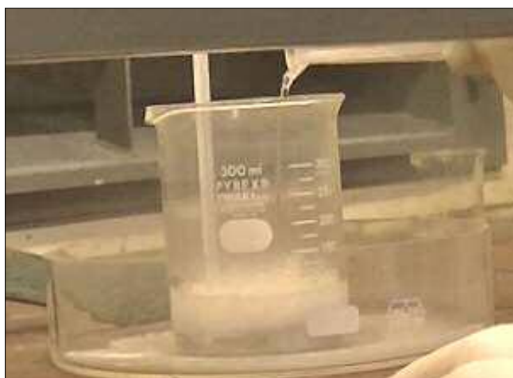
図9 硫酸に炭酸ナトリウム水溶液を加えた際の発泡状況
