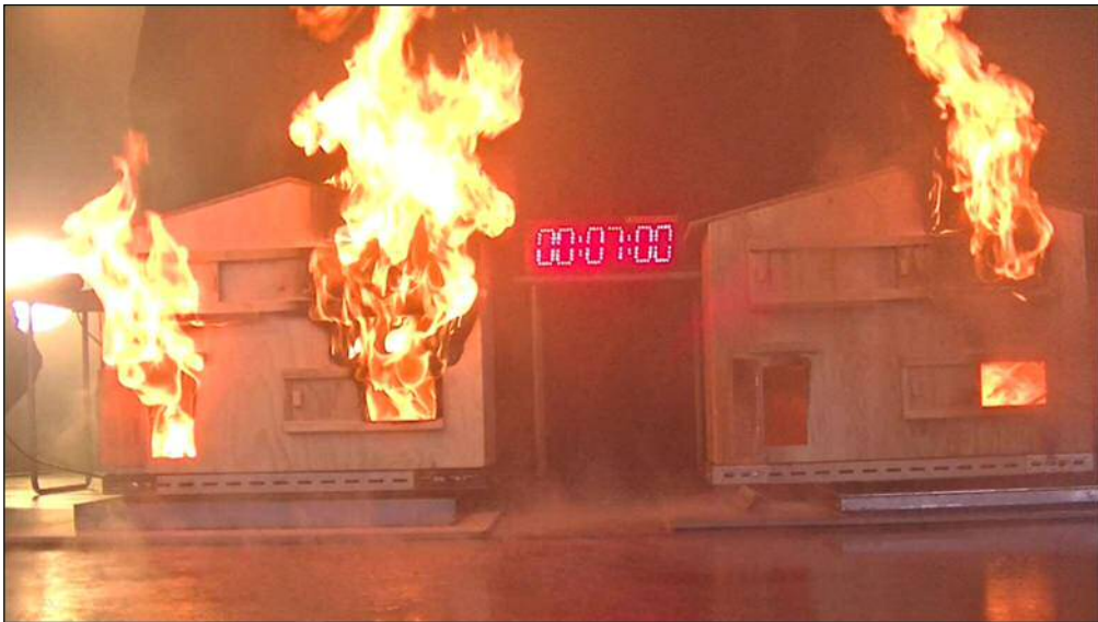
図 4 噴出する火炎の規模の比較（右模型：右下の部屋②で水力換気実施中）
