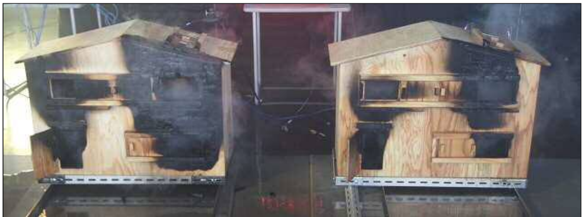
図 5 模型正面の焼損状況（左模型：水力換気なし、右模型：水力換気あり）
