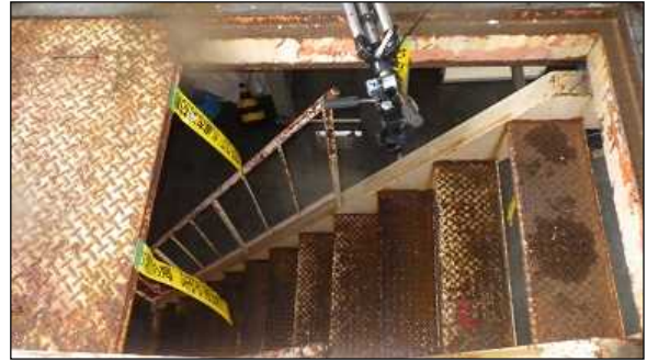
図 13 屋内階段(開口部)に設定した風速計
