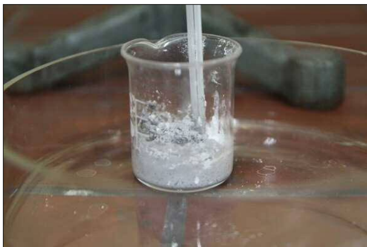
図8 かくはん後に硬化した状況（硫酸 10mL+ケムクレンズ粉末 1/4 量）
