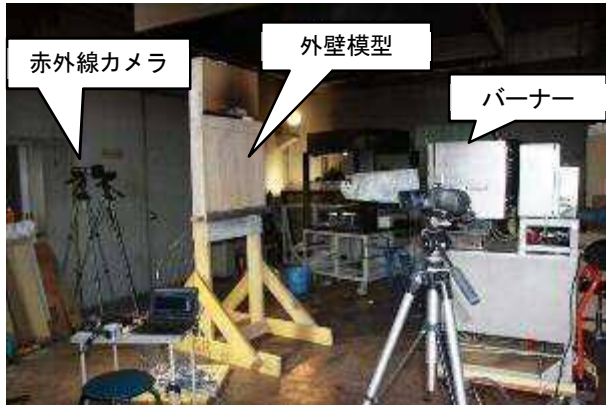
写真7 灯油バーナー設定状況
