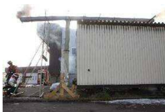
写真 11 T字ダクト燃焼状況
