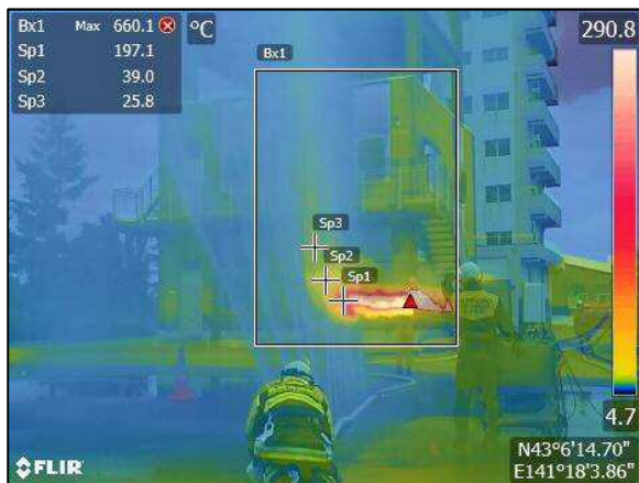
写真8 水幕形成時の延焼防止等の状況 (熱画像)
