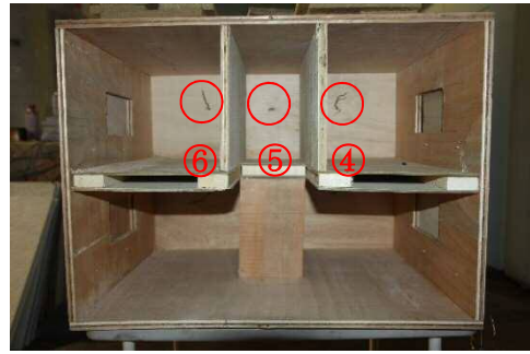
写真 20 熱電対設置位置
