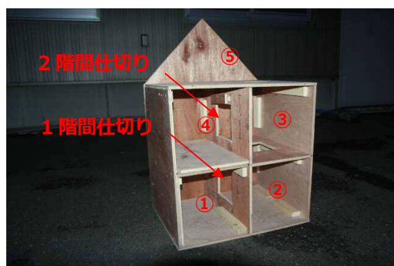
写真 12 1階間仕切り及び2階間仕切り(開放) ※前面コンパネ及び屋根コンパネ取外し
