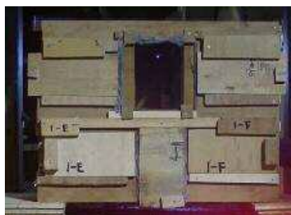
写真 10 条件 2 設定状況（2 階正面中央部のみ耐熱ガラス）
