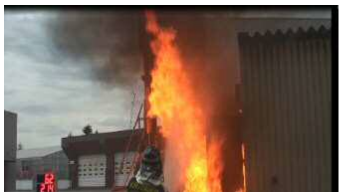
写真11 ユニットと鉄板の間を注水（ノズル角 30°）
