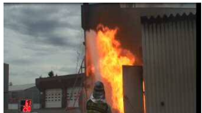
写真10 鉄板に向かって注水
