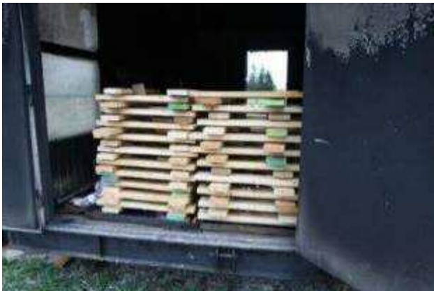
写真3 クリブ材設定状況
