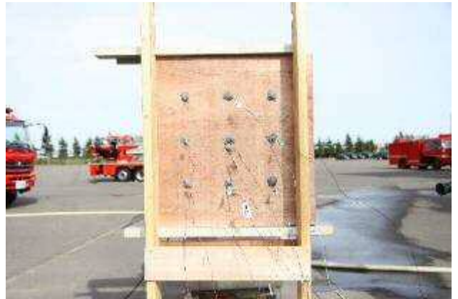
写真 13 熱電対設定状況
