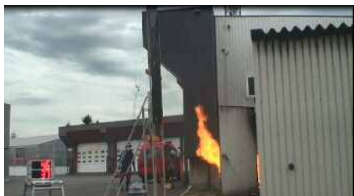
写真6 可搬式ブロアー稼働直後
