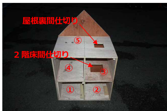
写真 11 2階床間仕切り及び屋根裏間仕切り (開放) ※前面コンパネ及び屋根コンパネ取外し
