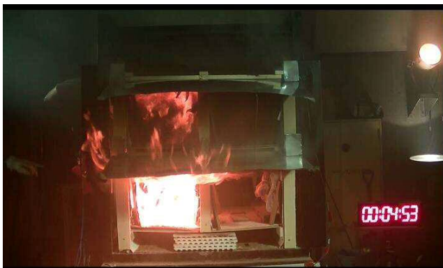
写真8 2階の可燃物が燃焼し延焼拡大
