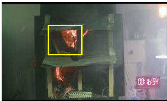
写真12 2階左部屋で火種と可燃性ガスが残存していたため、フラッシュオーバーが発生
