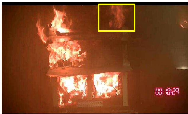
写真10 小屋裏右側から火炎が噴出し始める。
