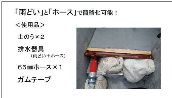
写真5 提案番号第598号 「ホースを使用した消火水の排出用器具の考案について」
