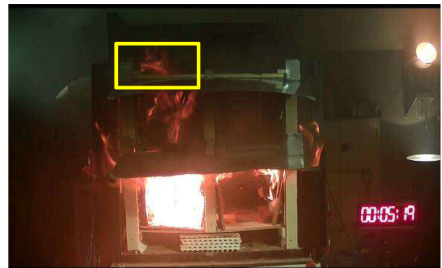
写真9 小屋裏及び火点室の隣室に延焼
