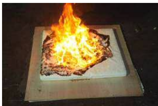
写真 25 液化した PE の燃焼 (3 分後)
