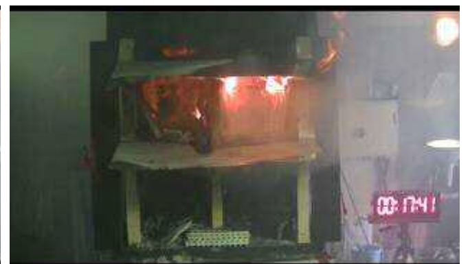
写真13 2階左部屋から右部屋のへ一気に燃焼拡大
