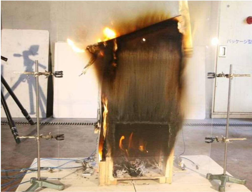
写真 33 実験 2 開始 29 分後 (屋根へ着火)
