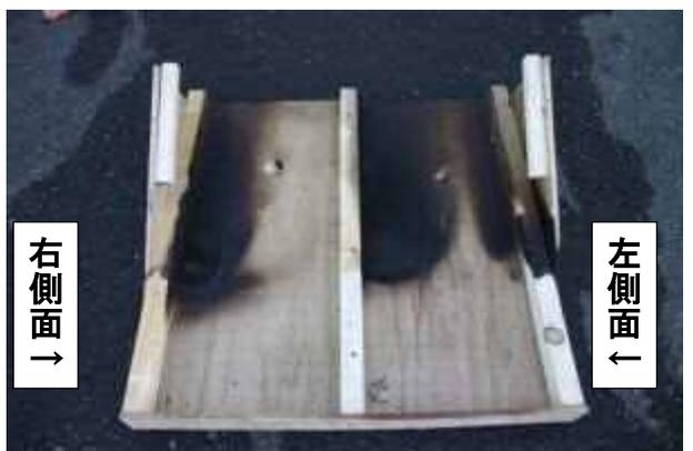
写真 56 実験 5 終了後の野地板下面
