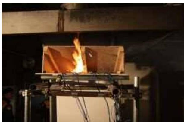
写真9 野地板延焼状況（実験1）
