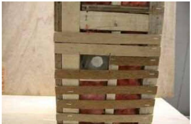
写真6 模型1 左側面換氣口 (壁体内部)
