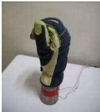
写真11 手型模型への旧型手袋装着状況
