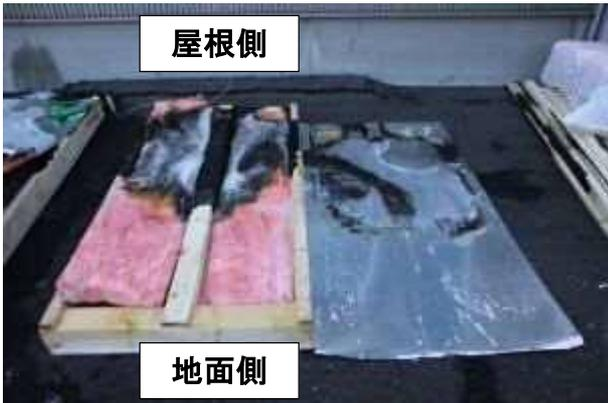
写真 31 実験 3 終了後の壁体内部（外壁側）
