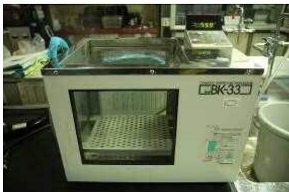
写真13 実験1で使用した恒温液槽
