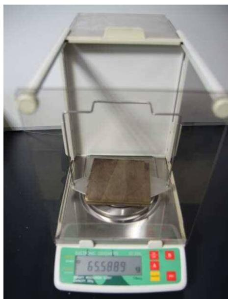
写真 16 板重量測定状況 (実験 3)
