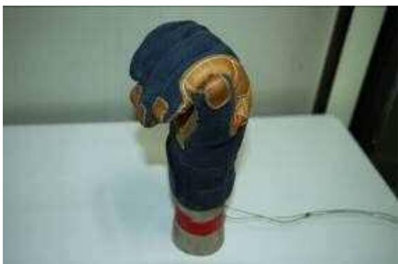
写真9 手型模型への新型手袋装着状況
