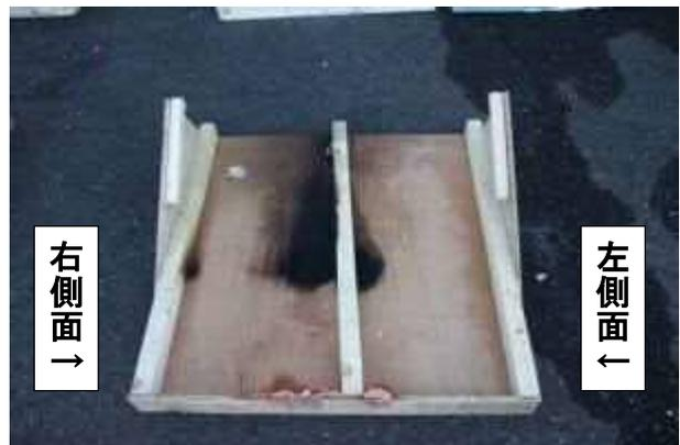
写真 34 実験 3 終了後の野地板下面
