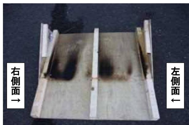
写真 24 実験 2 終了後の野地板下面
