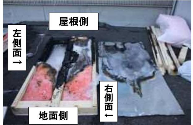
写真 52 実験 5 終了後の壁体内部（外壁側）
