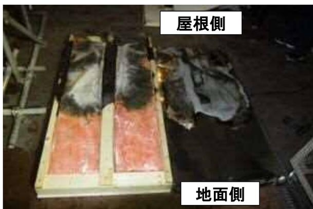
写真10 実験1終了後の壁体内部（外壁側）
