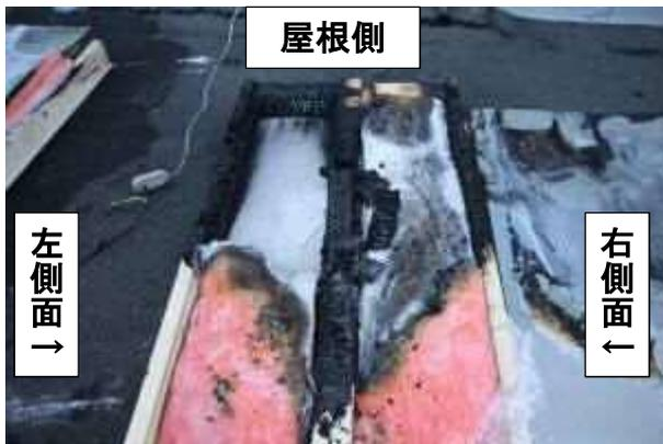
写真 53 実験 5 終了後の壁体内部（外壁側）
