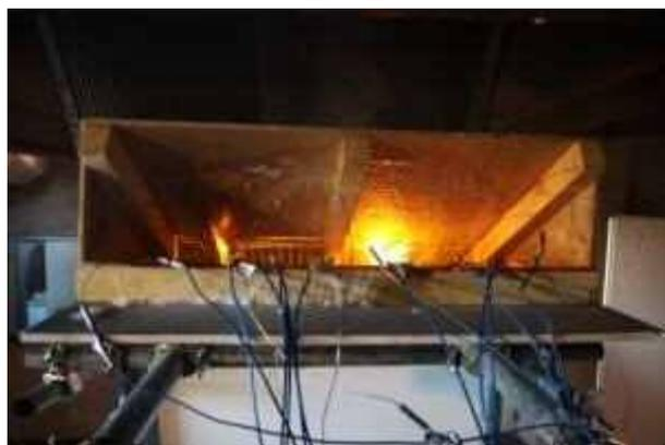
写真 18 野地板延焼状況 (実験 2)
