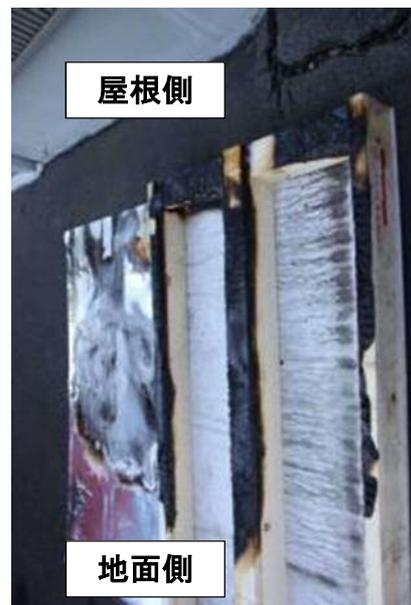
写真 22 実験 2 終了後の壁体内部 (外壁側)
