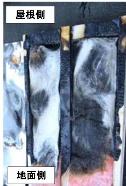
写真 20 実験 2 終了後の壁体内部 (外壁側)
