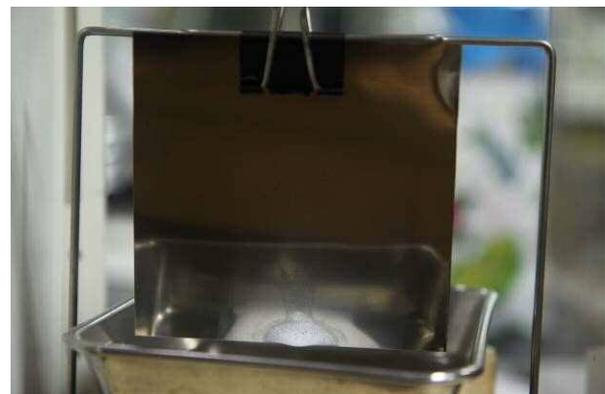
写真14 実験2状況(ステンレス板-ウェット泡)
