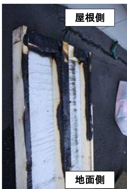
写真 23 実験 2 終了後の壁体内部 (外壁側)
