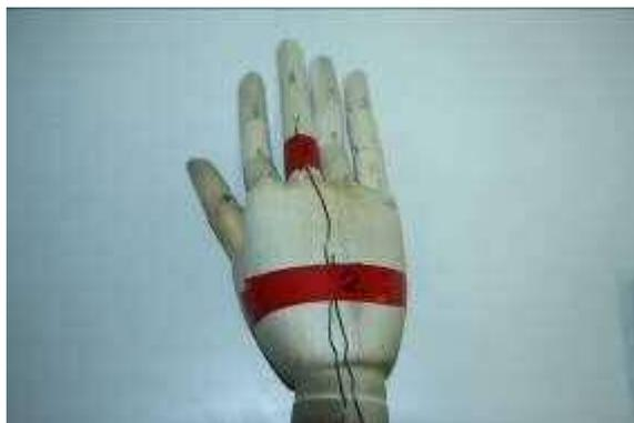
写真8 手型模型のK型熱電対温度計設置箇所
