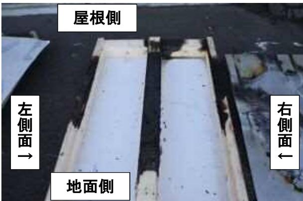
写真 33 実験 3 終了後の壁体内部（外壁側）
