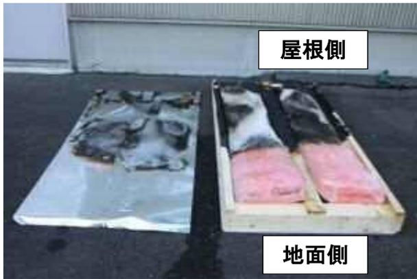
写真 19 実験 2 終了後の壁体内部 (外壁側)
