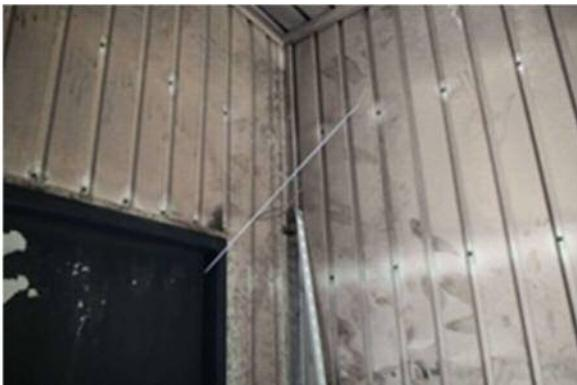
写真 17 室内下部の熱電対 (CH2)
