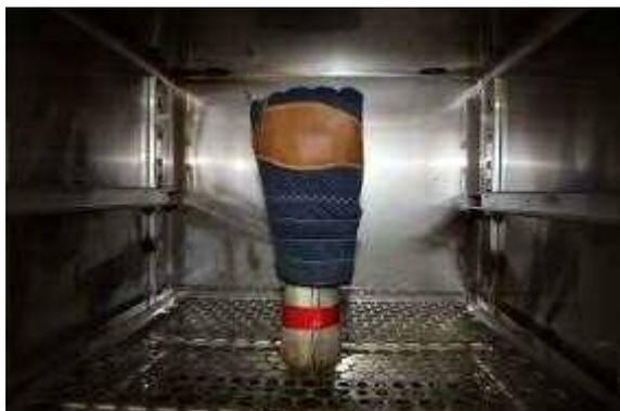
写真 21 定温乾燥器内への手型模型設置状況
