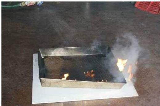
写真 11 散水栓により消火
