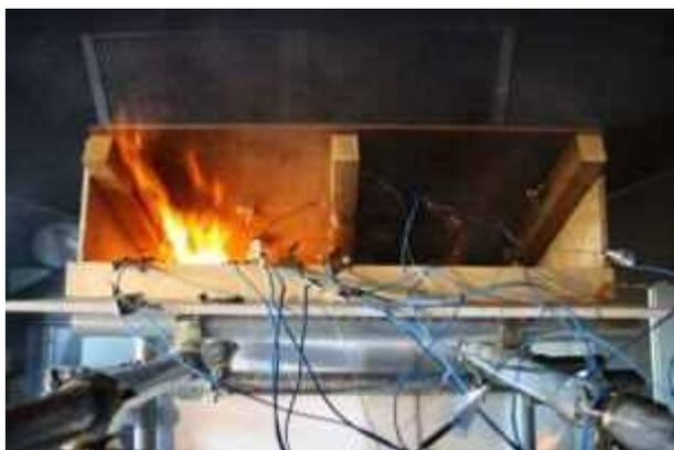
写真 47 野地板延焼状況 (実験 5)
