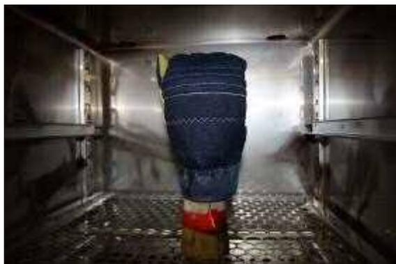
写真 22 定温乾燥器内への手型模型設置状況
