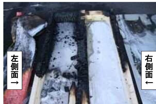
写真 55 実験 5 終了後の壁体内部（外壁側）
