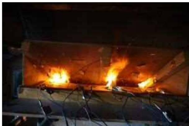
写真 38 野地板延焼状況 (実験 4)
