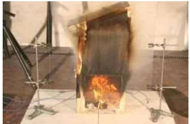
写真 30 実験 2 開始 26 分後 (壁体内延焼)
