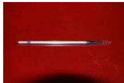
写真 4 検知管の状況
