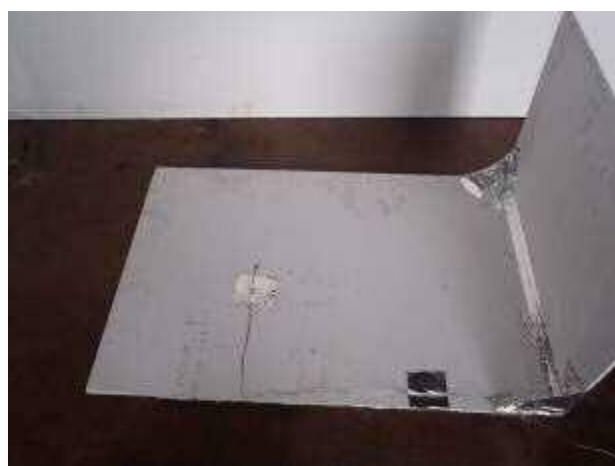
写真6 熱電対設定状況1 （ケイ酸カルシウムボード上面）
