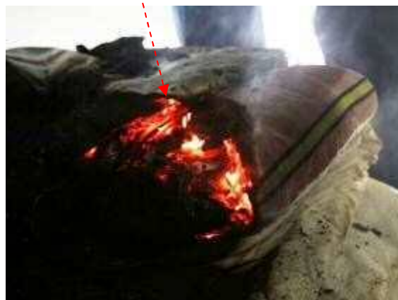
写真 34 3層目綿布団① (送風状態)
