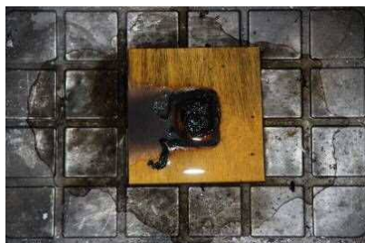
写真6 自然鎮火後水をかけたタオル
