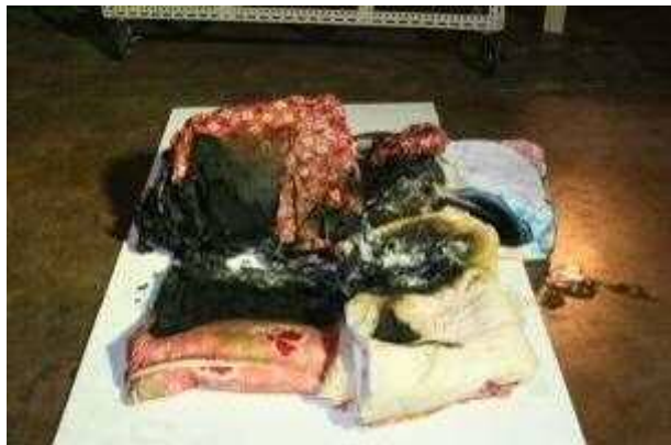
写真 2 6 事前実験 4 終了時 (前面) 綿③④と化繊②③の間
