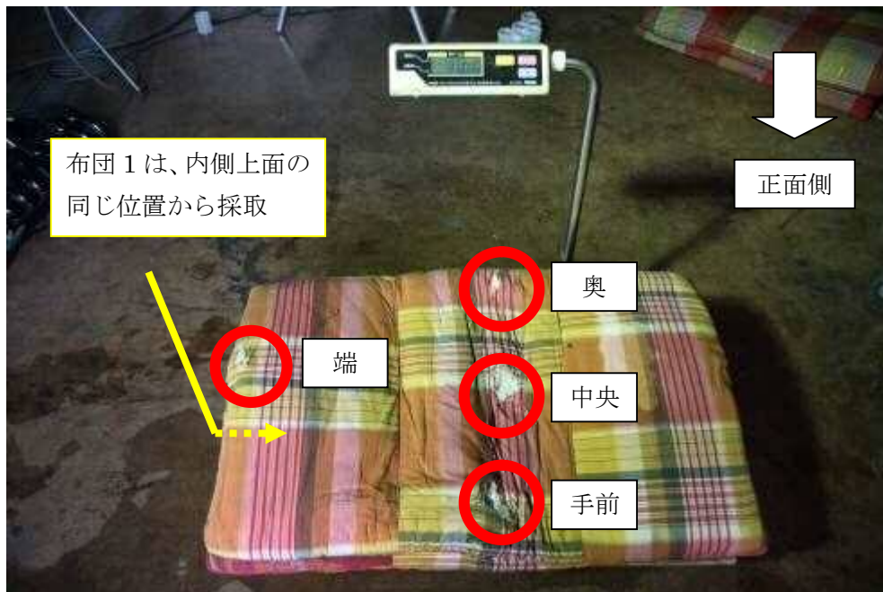
写真5 布団2の重量計測状況及び中綿採取位置
