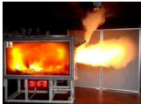
写真7 バックドラフト発生時の状況2
