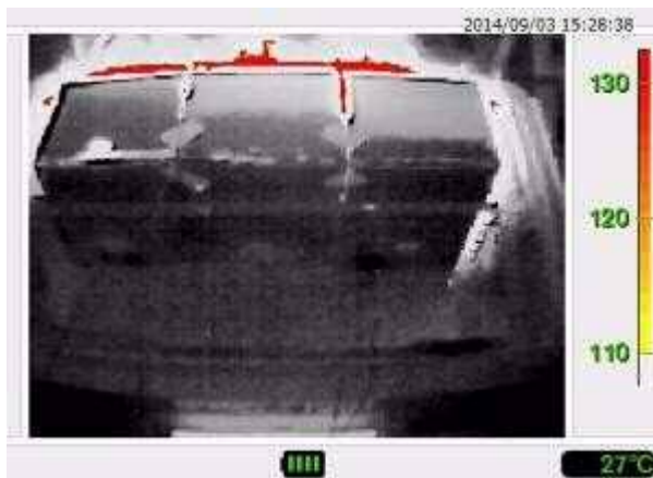
写真 20 ケイ酸カルシウムボード下面の熱画像 (実験開始 40 秒後)
