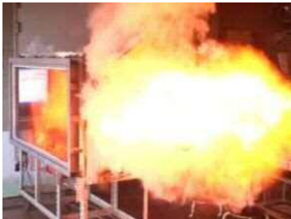
写真6 バックドラフト発生時の状況1
