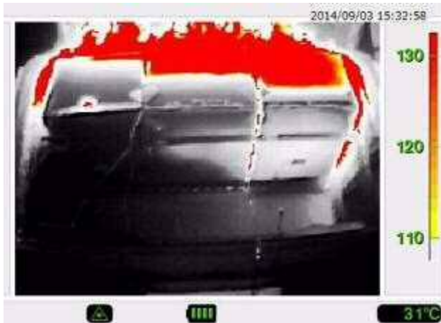
写真 2 4 ケイ酸カルシウムボード下面の熱画像（実験開始 300 秒後）
