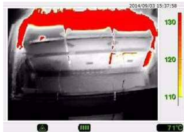
写真 2 7 ケイ酸カルシウムボード下面の熱画像（実験開始 600 秒後）
