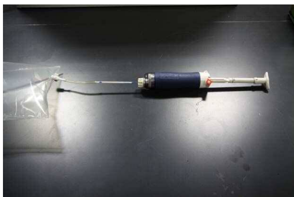
写真1 検知管Aの検査状況
