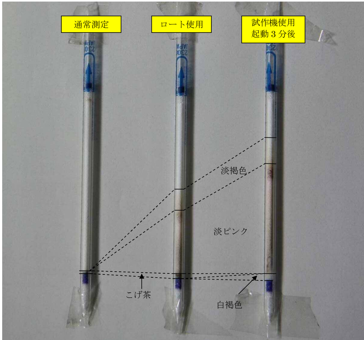
写真 18 キ ポリ塩化ビニル-1 分燃焼-常温
