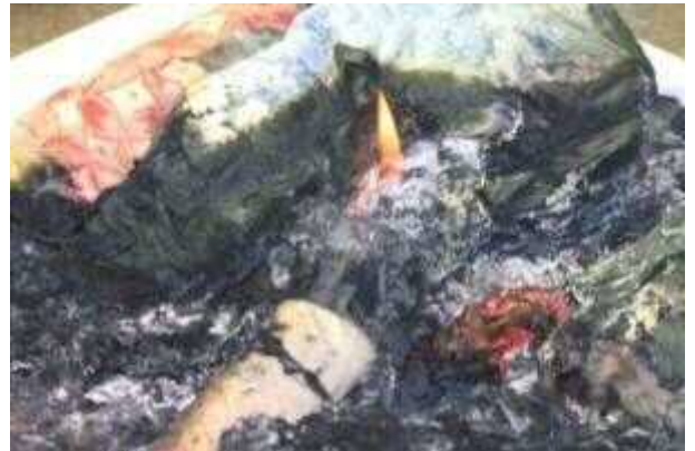
写真31 事前実験4終了後、綿②へ送風し炎が出た状況
