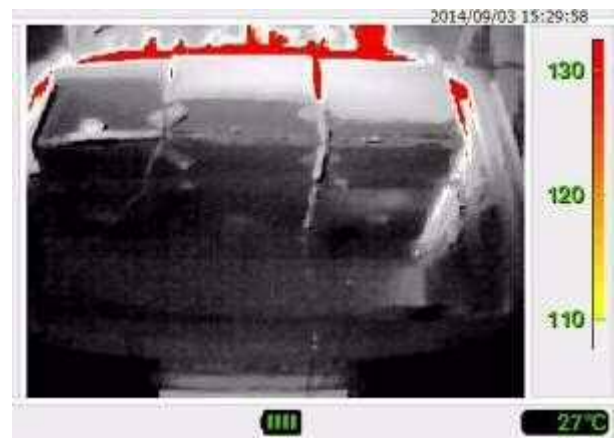
写真 21 ケイ酸カルシウムボード下面の熱画像 (実験開始 120 秒後)
