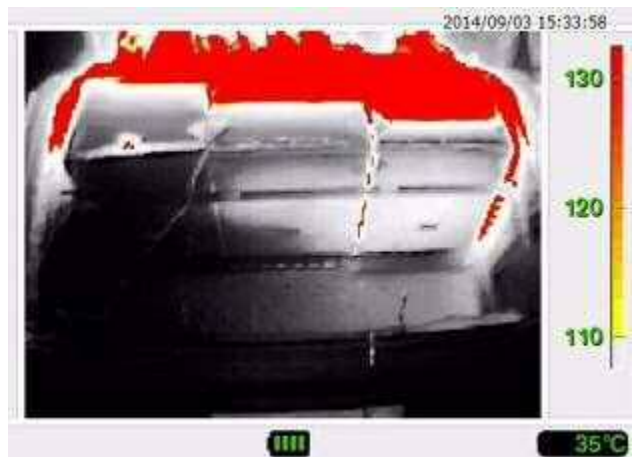
写真 2 5 ケイ酸カルシウムボード下面の熱画像（実験開始 360 秒後）
