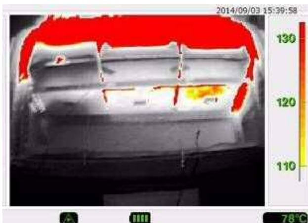
写真 2 8 ケイ酸カルシウムボード下面の熱画像（実験開始 720 秒後）
