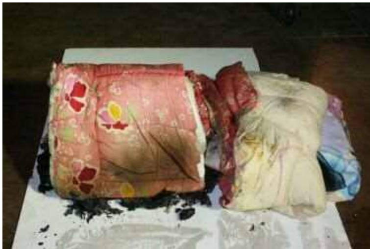
写真29 事前実験4終了時 化繊②及び化繊③下面
