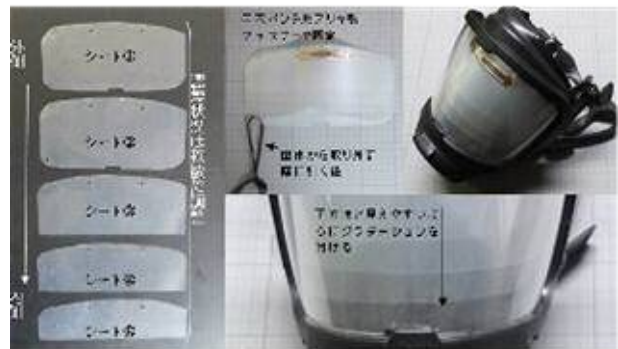
写真4 空気呼吸器面体用濃煙疑似シートの開発
