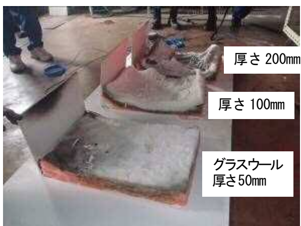
写真30 実験終了後のグラスウール(左側面)
