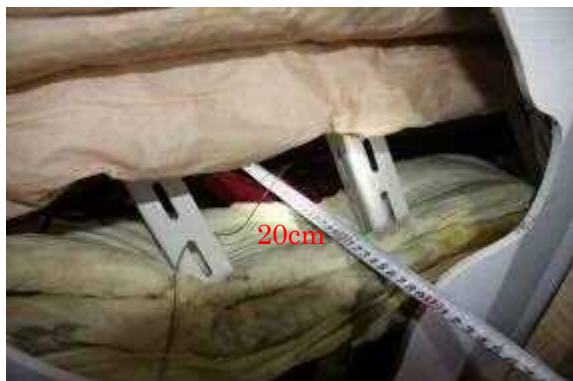
写真4 火源設定位置の状況（背面側から撮影）
