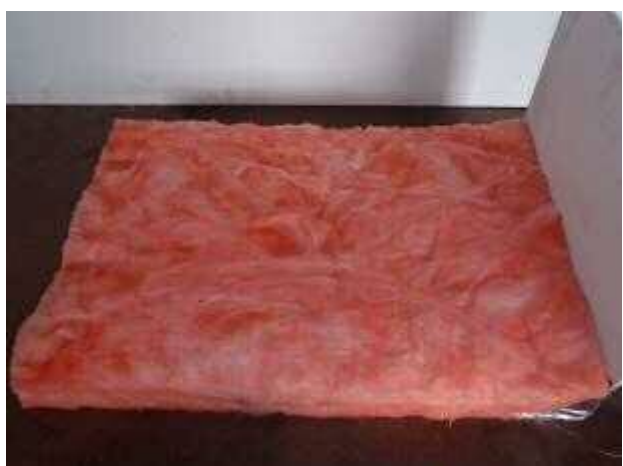
写真7 ケイ酸カルシウムボード上面へのグ ラスウール設定状況
