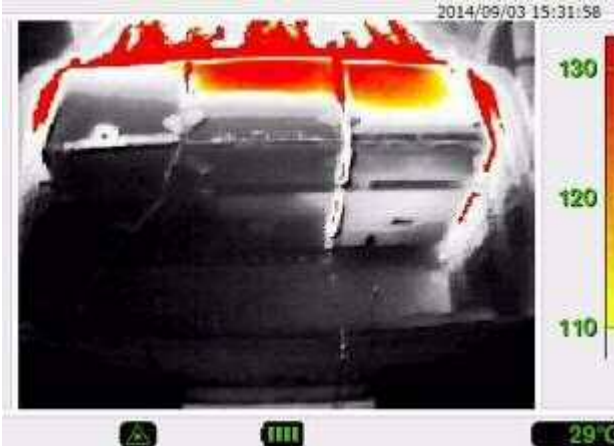
写真 23 ケイ酸カルシウムボード下面の熱画像 (実験開始 240 秒後)
