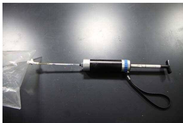
写真2 検知管Bの検査状況
