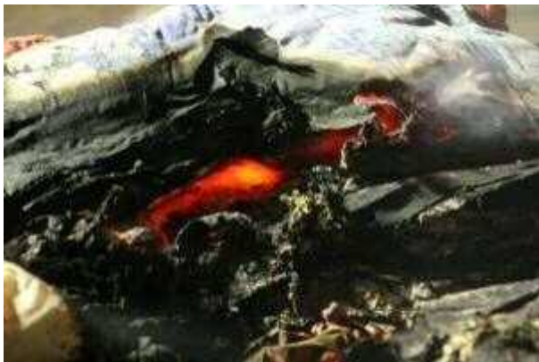
写真30 事前実験4終了時(綿②内部)
