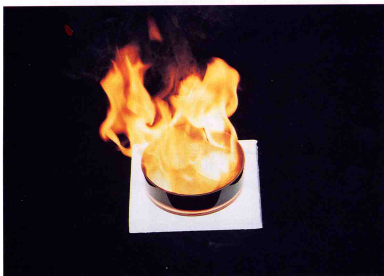
写真3 燃烧灯油の作成状況 (180mmシャーレ)
