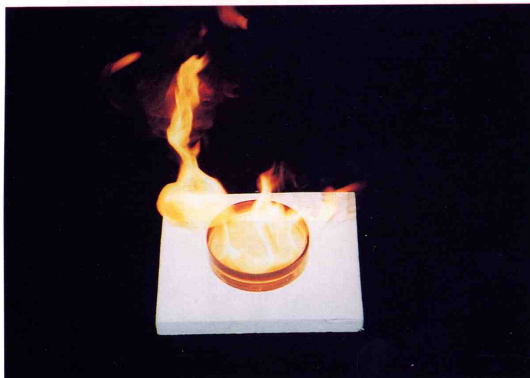
写真2 燃烧灯油の作成状況 (120mmシャーレ)
