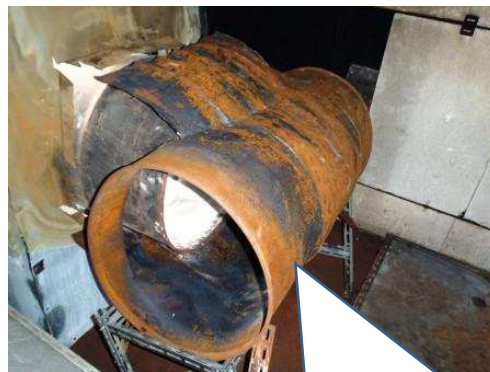
燃焼筒（外筒）：ドラム缶 2 本を T 字状に加工
