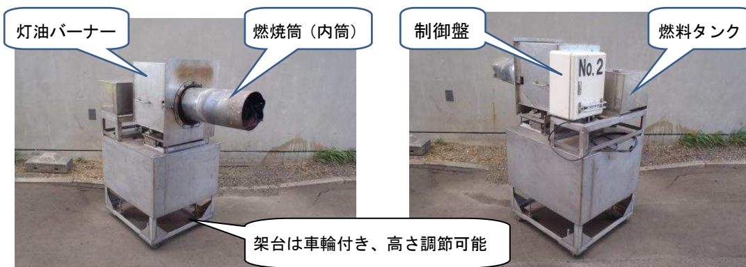
写真 No. 3 熱源装置
