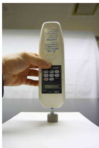
写真15 低温下における硬さの変化の比較実験状況
