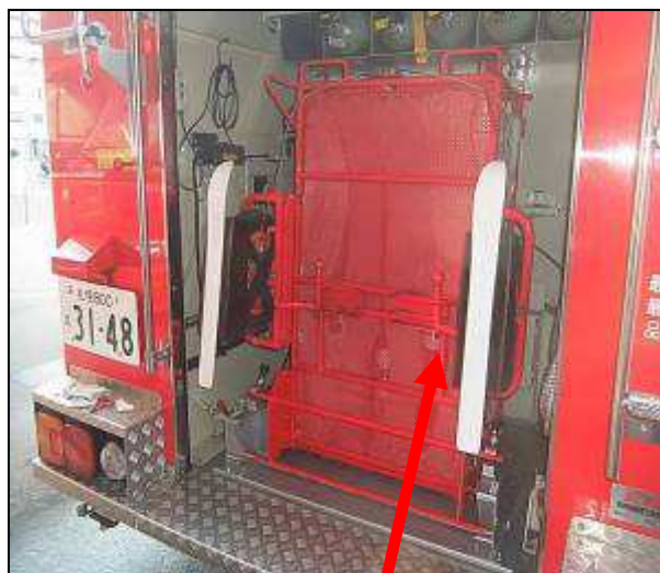
ホースカーを降ろす前に、車輪に固定する。
