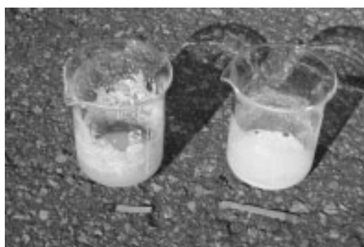
写真 15 混合割合による反応液の相違 左：アルカリ性、右：酸性
