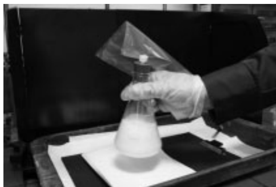
写真6 気泡の気体成分採取状況
