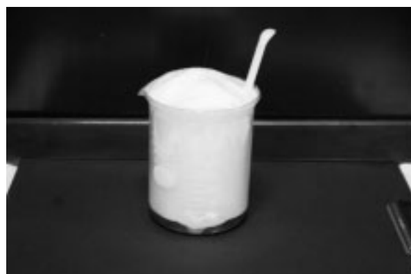
写真8 炭酸水素ナトリウム粉末による中和
