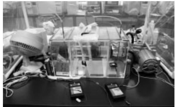
写真 2 フィルターを取り付けたCO除去性能実験装置
