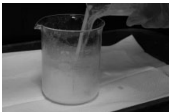
写真5 粉石けん水溶液中での中和状況
