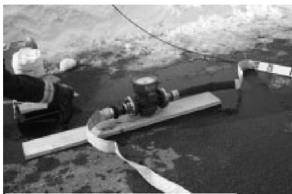
写真4 流量計の設定状況
