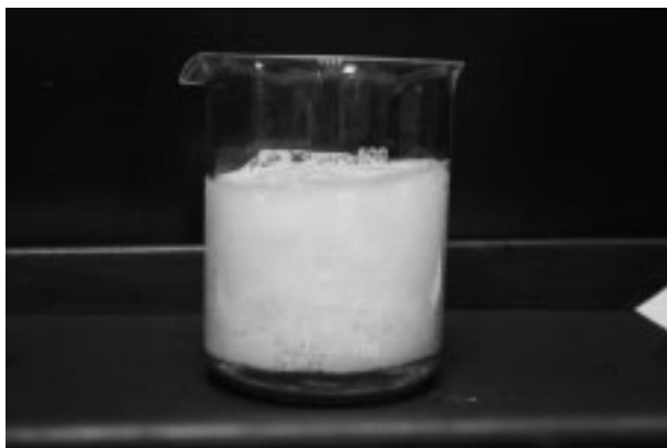
写真9 炭酸水素ナトリウム水溶液による中和
