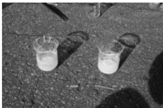
写真 16 炭酸ナトリウムによる中和実験
