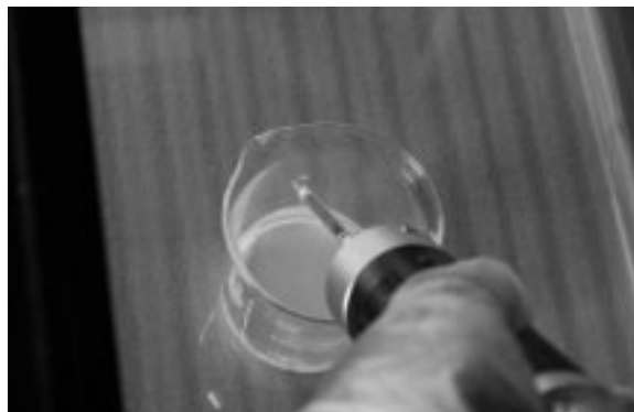
写真 13 検知管による検知状況
