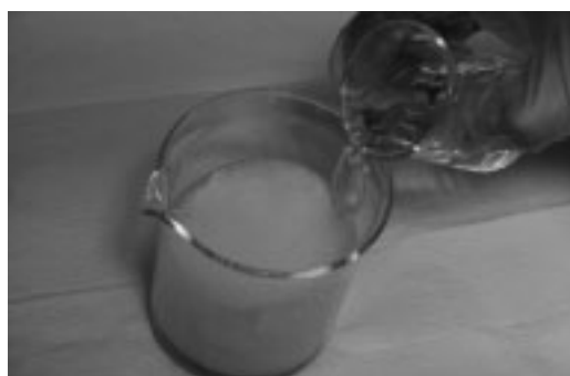
写真 3 炭酸ナトリウム溶液での中和
