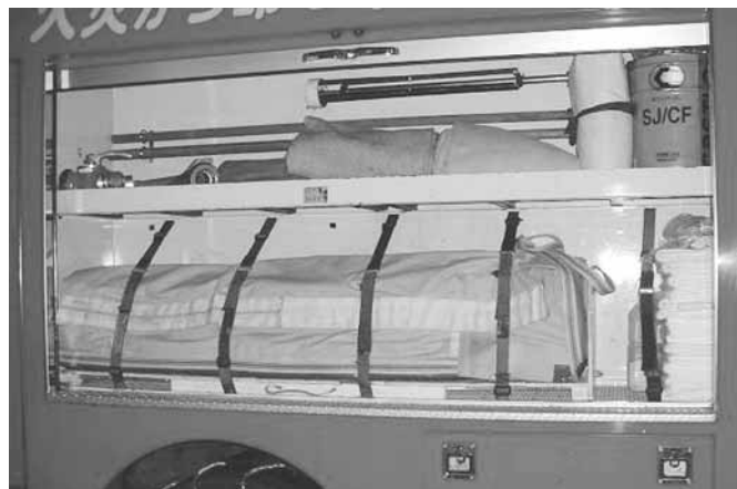
ホース搬送用バック（バックを開け通常延長も可能）
