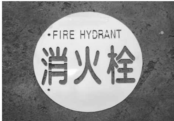
消火栓標識塗装用型枠
