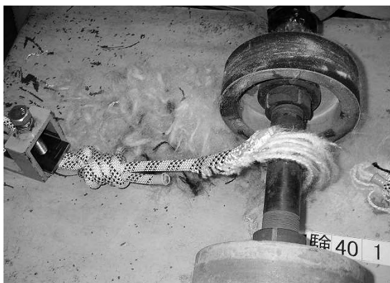
写真21 磨耗による破断状況
