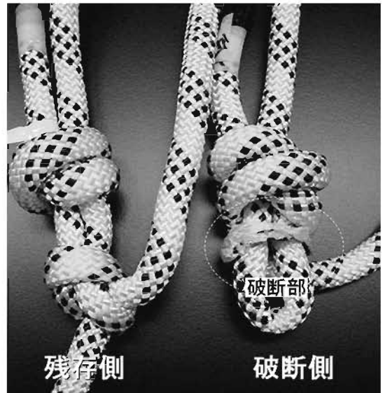
写真29破断状況 (ブーリンノット)
