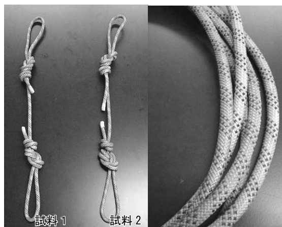
写真14 摩擦により受熱したロープ
