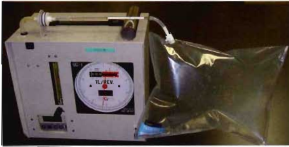
図6 ガスをテナックスTAに吸着させる様子
