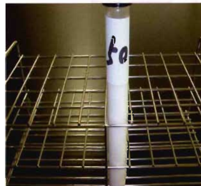
写真11 乳化白濁した状態
