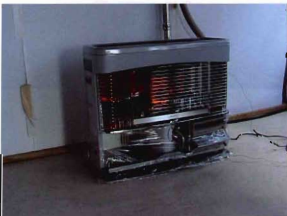
写真13 正常燃焼時の状況
