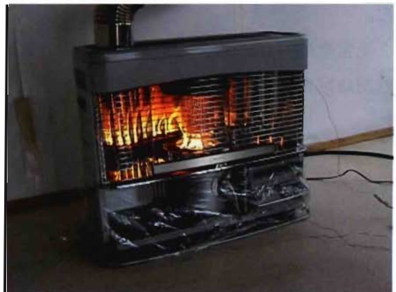
写真12 異常燃焼時の状況
