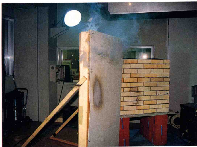
写真12 壁体上部からの白煙の発生状况
