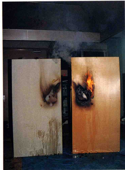
写真13 壁体内部ベニヤ板の酸素供給による発炎状况
