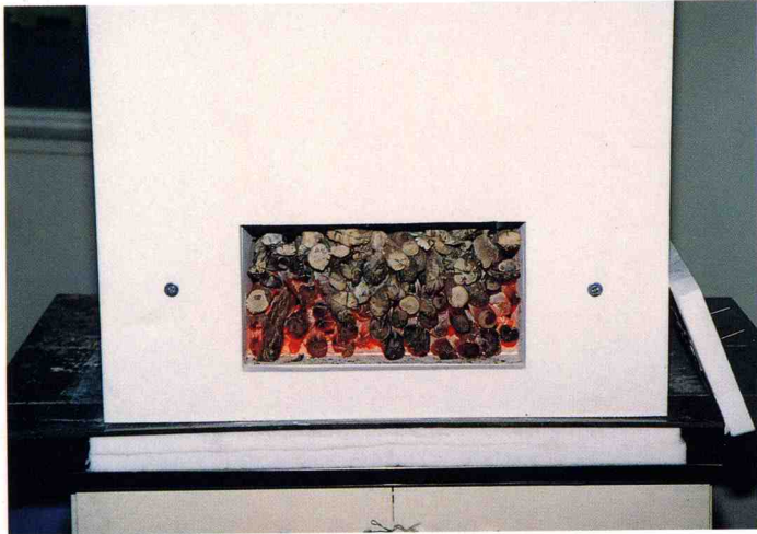
写真11 焚き口の炉表面温度測定用代替モデル （開口部寸法，w 300×h 160 mm）
