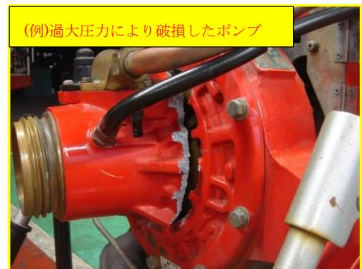
C-1 級ポンプには、付属で自動中継弁（減圧弁）を配置しており、有圧水利から吸水する際は、吸水口の前に当器具の装着を徹底すること。
