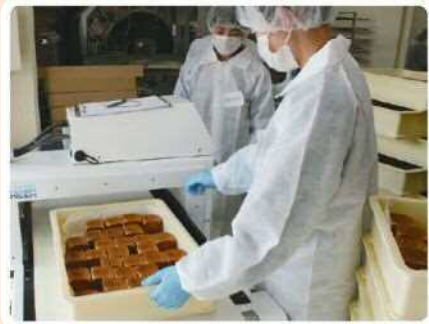
▲袋詰めする前に製品チェック。金属探知機を通して、わずかな金属も混入していないか調べます。
