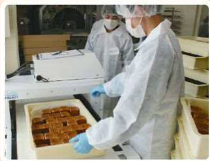
▲袋詰めする前に製品チェック。金属探知機を通して、わずかな金属も混入していないか調べます。
