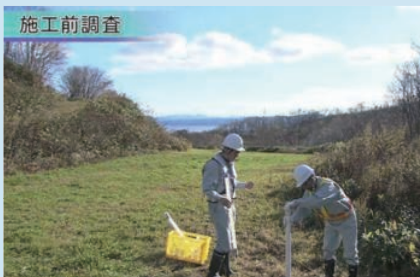
地下水の深さを調査
