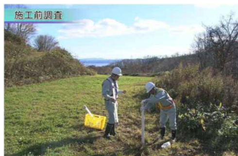
地下水の深さを調査
