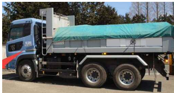
荷台のシート養生やタイヤ洗浄
