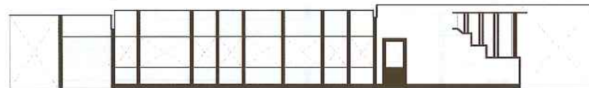
改修例2) 前面に腰壁+開口部 (+筋交い)
