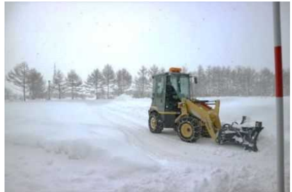
ホイールローダーによる除雪作業
