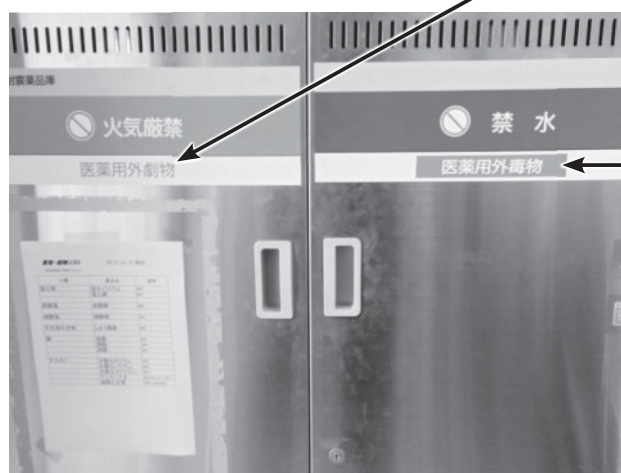
毒物・劇物の薬品収納庫（薬品庫）
