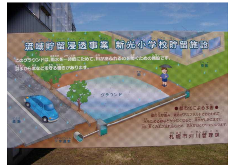
資料16-3 小中学校の雨水貯留施設
