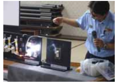
「トラック」現象の実験の様子
