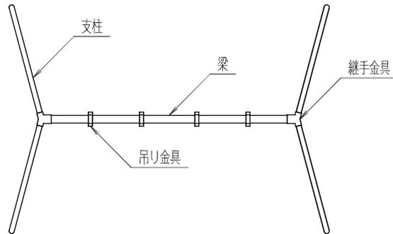
吊り金具・・・軸受金具・振り子金具・回転軸
