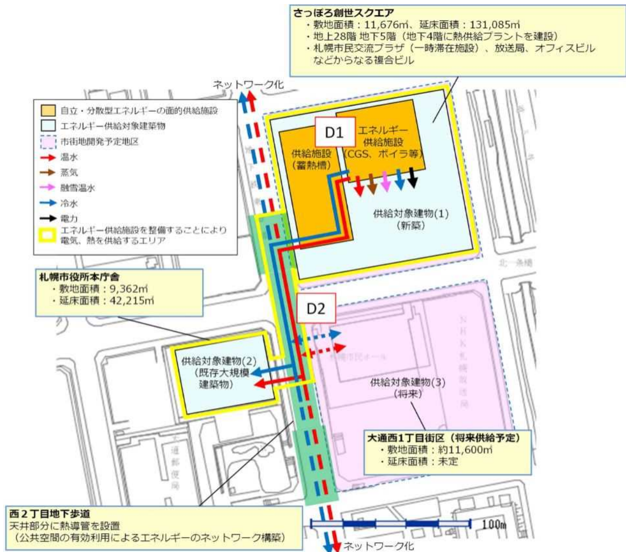
図 16 札幌駅・大通駅周辺地区都市再生安全確保計画図 D1 創世エネルギーセンター及び D2 西2丁目地下歩道熱導管ネットワーク 詳細
