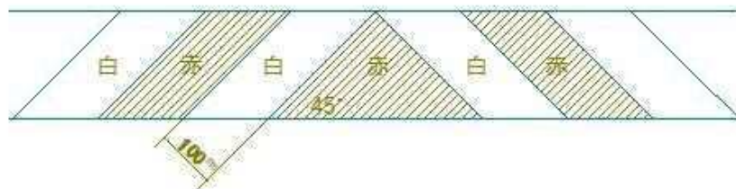
(3) パトロール車、普通作業車、除雪機械[除雪トラック、凍結防止剤散布車、除雪グレーダ、ロータリ除雪車(歩道用凍結防止剤散布車を含む)、除雪ドーザ]の塗色要領図(危険表示)
