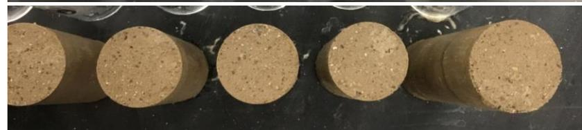
一次元模型注入実験における薬液の浸透状況
