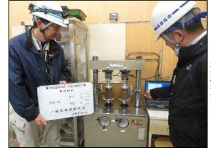
道路部の強度試験結果 ※1000kN以上で合格
