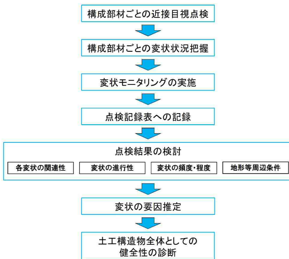
図3-8 特定道路土工構造物点検の流れ
