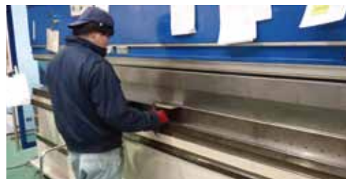
金属板を折り曲げるプレス加工
