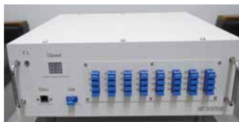
回線1は1分ごと、回線2は30分ごとなど測定周期を回線ごとに細かく設定できるHITシステムのチャンネルセレクター。写真は32回線のもので、最大100回線まで対応可能
