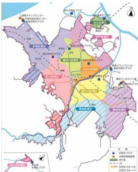
図 下水道施設の配置状況
