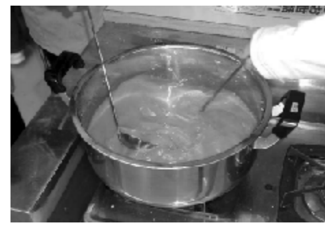
廃油を熱し、凝固材を混ぜているところ
