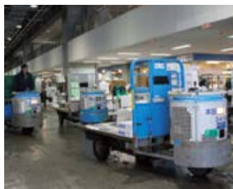
天然ガスを燃料として走る構内運搬車
