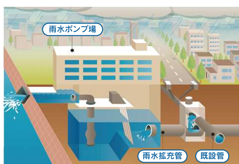
雨水ポンプ場、雨水拡充管のイメージ
