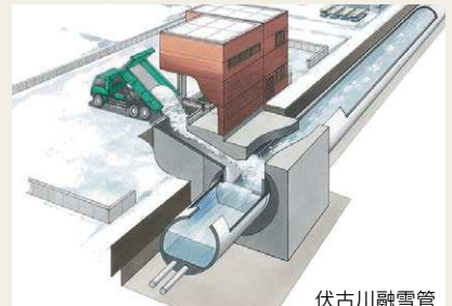
伏古川融雪管
