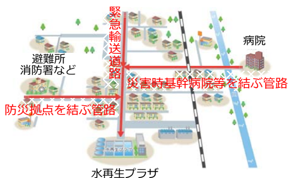
被災時の影響が大きい管路
