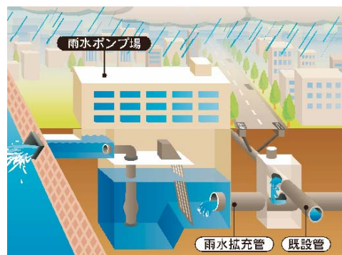
雨水ポンプ場のイメージ
