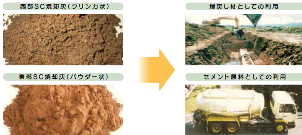
下水汚泥の有効利用
