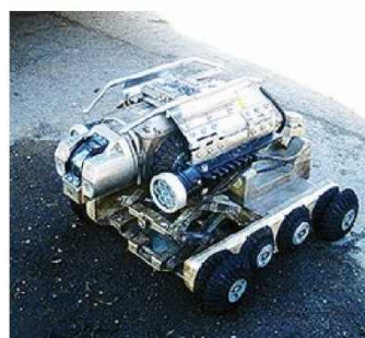
テレビカメラを用いた管路の詳細調査
