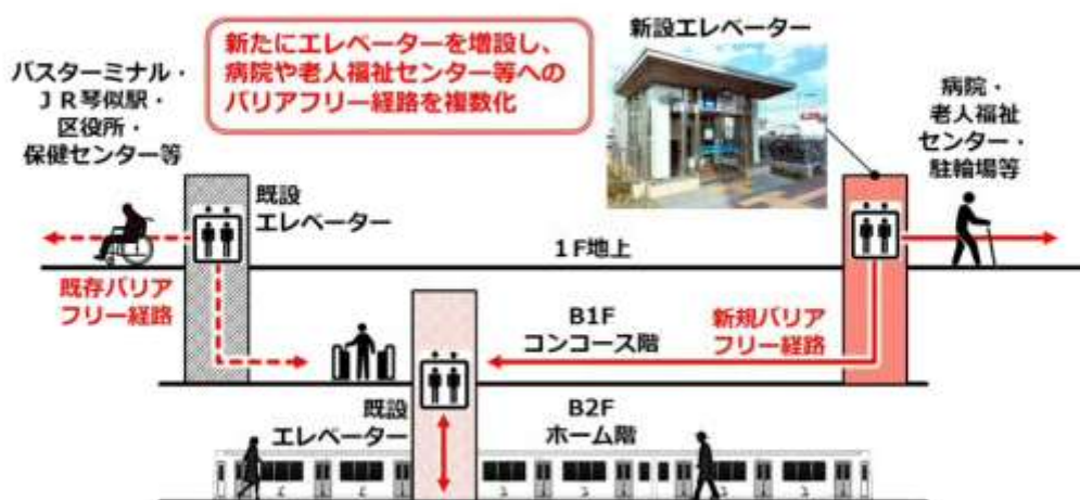
図 2-2 エレベーターの複数設置の事例（地下鉄琴似駅）
