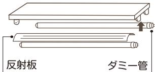
ダミー管を使用することで、2灯型の蛍光灯器具を1灯だけ点灯することが可能です。また、反射板を組み合わせることで、照度を補えます。
